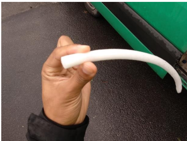
Wkładka ściśliwa zmniejszająca głębokość szczeliny = kord = sznur
