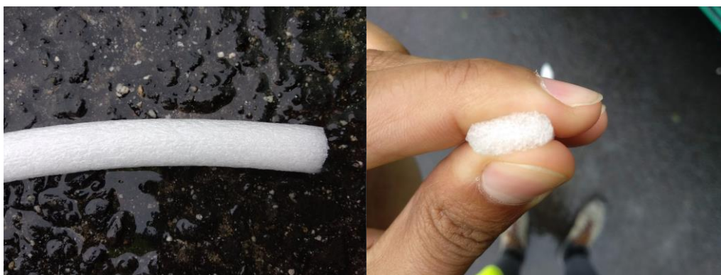
Wkładka ściśliwa zmniejszająca głębokość szczeliny
