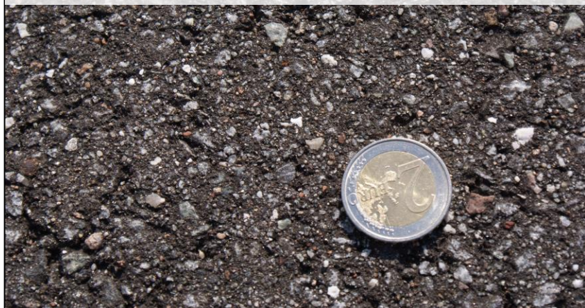
Tor badawczy (Niemcy) Nawierzchnia ISO 10844
