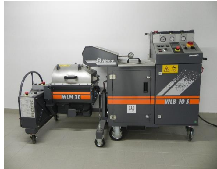
Rys.5. Urządzenie laboratoryjne do wytwarzania asfaltu spienionego
